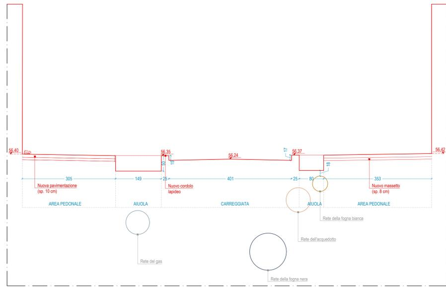
S1: Sezione di corso V. Emanuele, con indicazione dei sottoservizi (incrocio con via A.Volta) | 1:50
